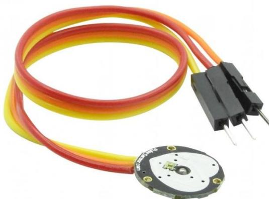
Рисунок 3.9 – Датчик пульса
